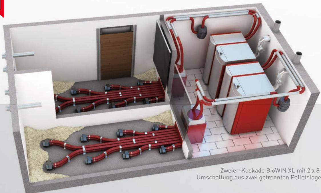
Zweier-Kaskade BioWIN XL mit 2 x 8-Sonden-Umschaltung aus zwei getrennten Pelletslagerräumen
