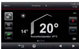
5-Zoll-Farb-Touch-Display der Regelung Vitotronic 200 (Typ HO2B)
